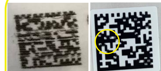
Смазывание кода маркировки или его отдельных элементов
