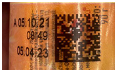
Печать кода маркировки на бликующей/светоотражающей поверхности
