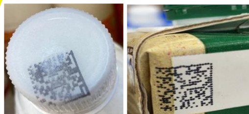
Смещение кода маркировки при печати
