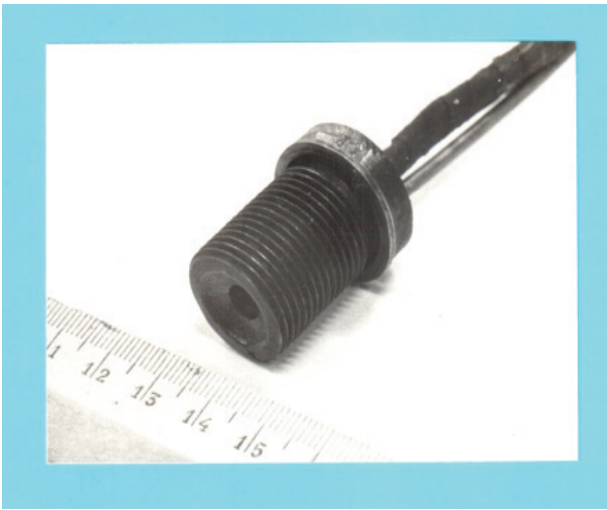
Рис. 4. Общий вид датчика радиационного теплового потока Fig. 4. Common outlook of apparatus radiative heat flux
